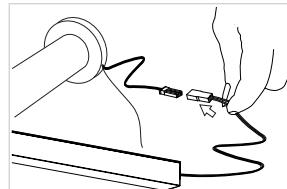
Enchufe la batería con el cable de alimentación del motor.
